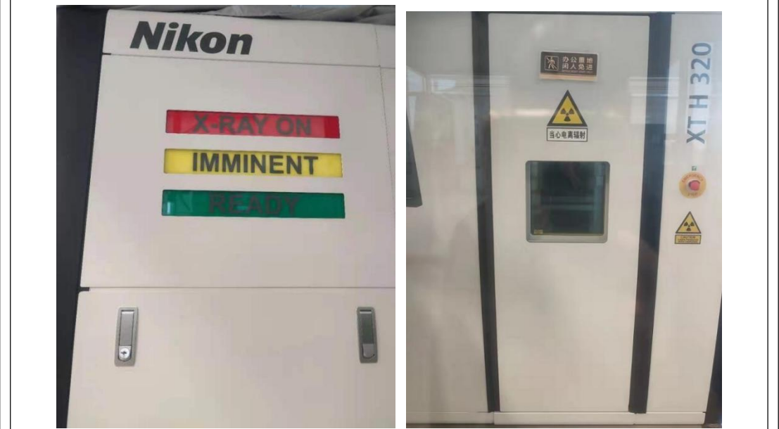
设备上工作指示灯和电离辐射警示
