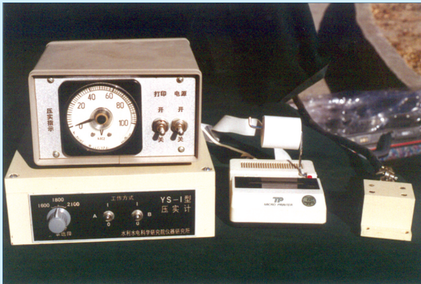
YS-1 型压实计组成部分（传感器、信号处理器、指示仪表、微型打印机）
