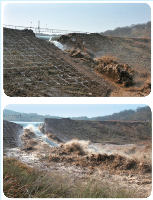
大尺度实体溃坝实验场（坝高 9.7m）
