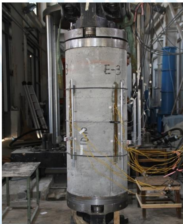
图 1 全级配混凝土拉压加卸载循环全过程试验装置
