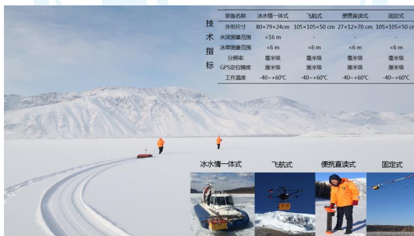
图 2 冰水情一体化双频雷达测量成套装备、指标与应用
