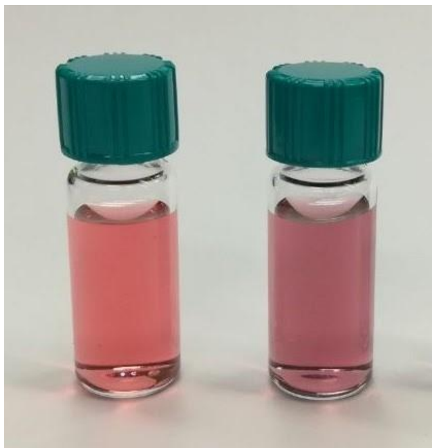
金纳米颗粒溶液接触砷后变色。
