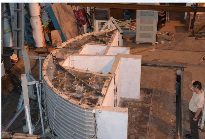
CAP1400 内置换料水箱流固耦合相似模型
