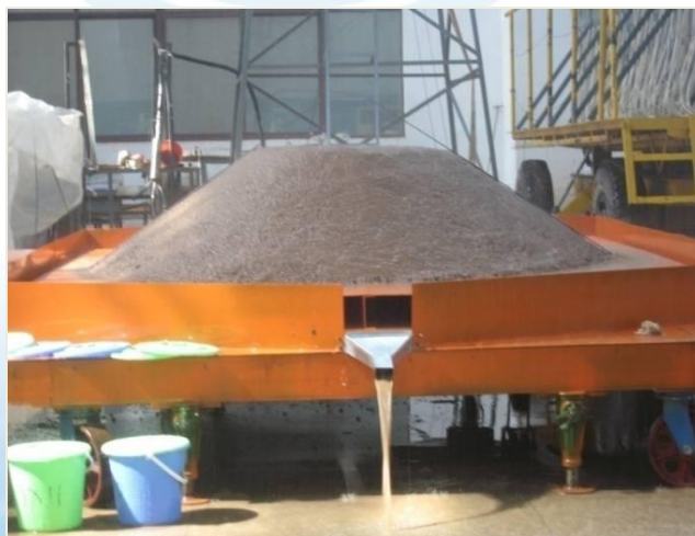
工程堆积体土壤流失实验
