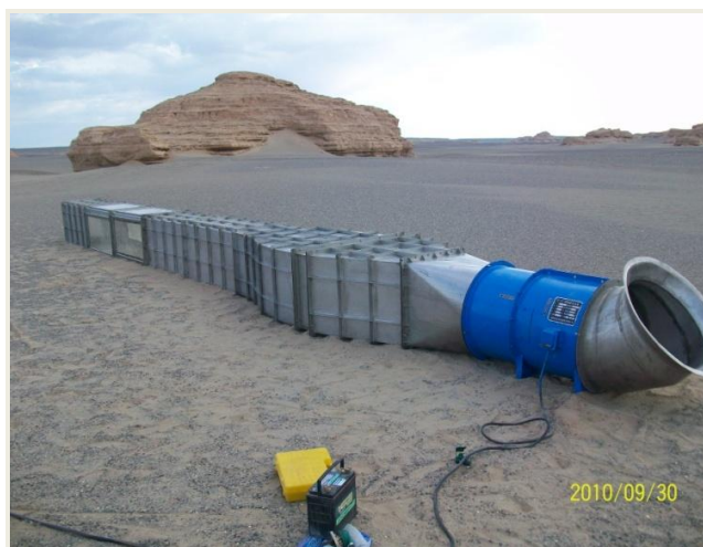
风力作用下扰动地表风洞实验
