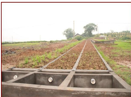
60m 长坡观测小区
