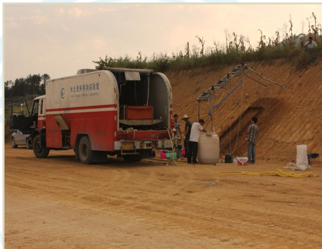
工程开挖面土壤流失人工降雨实验
