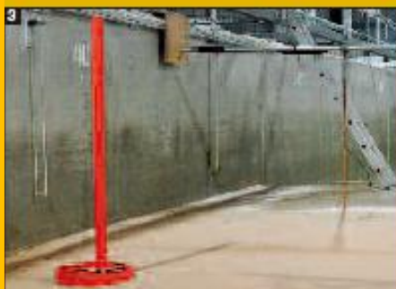
图 3—冲刷试验之前的测波仪、吸力式桶桩和 Vectrino（右）
