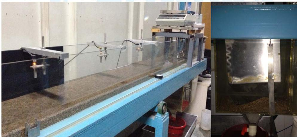
坝下清水冲刷条件下推移质输沙及河床二次粗化规律试验
