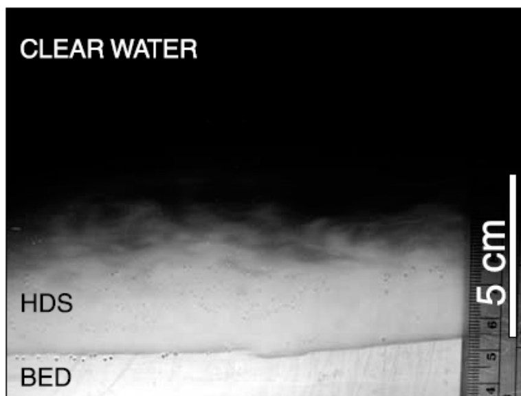
图 3-2 U 型往复流水道中的临底高含沙层(图中 HDS 所指)输移现象(取自 Lamb 等 2004)
